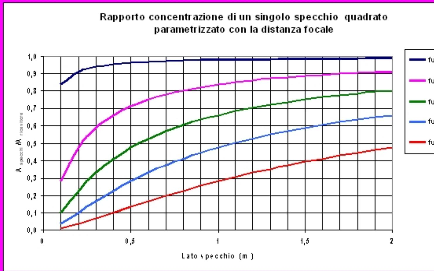
Fig. 4.83: Rapporto di concentrazione di un singolo specchio quadrato parametrizzato con la distanza focale  $f$  e il lato  $d$  del ricevitore  $d_r$  per un dato rapporto di concentrazione  $C$  è dato da:
