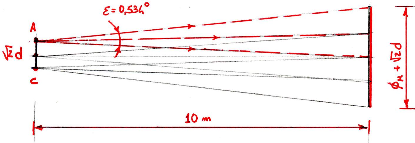
Fig. 4.1.27 – Formazione di macchia solare da specchio piano
