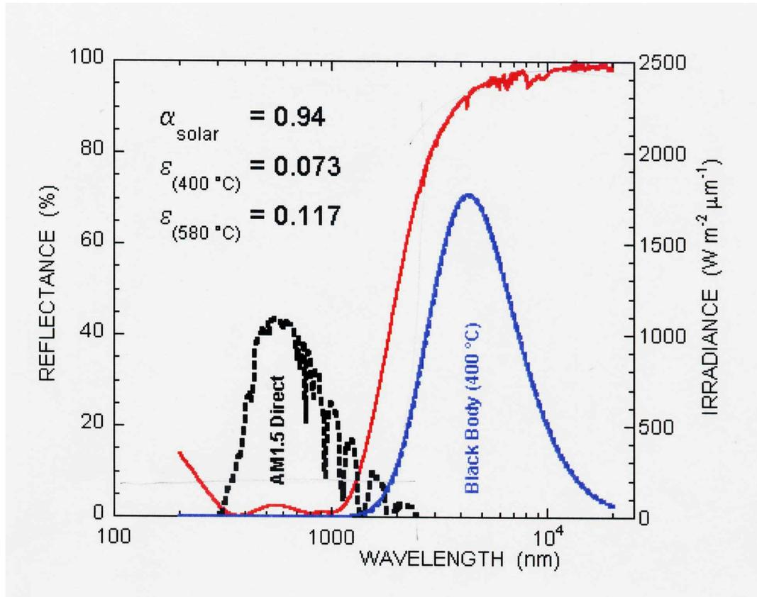
Fig. A4.24 – Dati del ricevitore selettivo progetto “Archimede”
